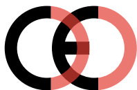
Faux marquage CE (trop proche)
